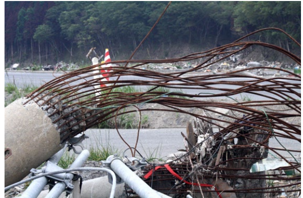
「町のいたるところに電信柱の鉄筋が」 2011年6月21日 南三陸町志津川にて
